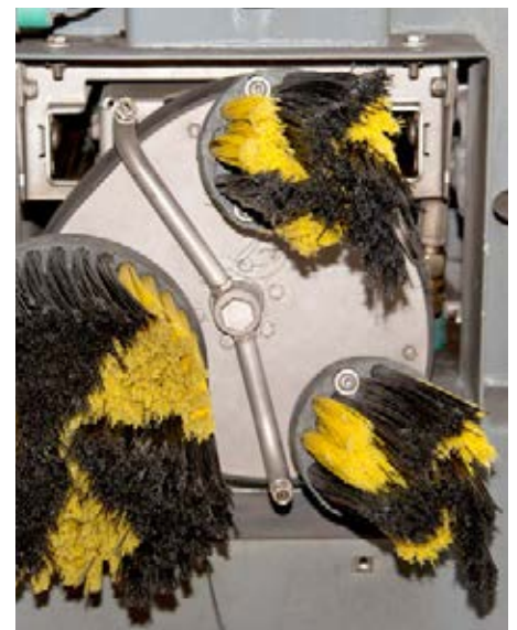
Für saubere Felgen konzipierte Kärcher das Patent mit drei rotierenden Rundbürsten.
