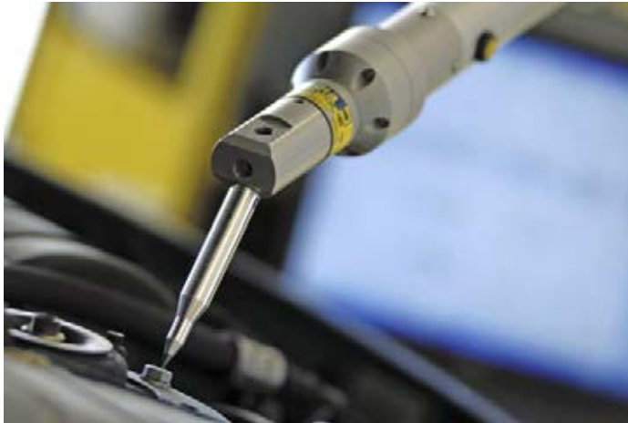
Die Messspitze des Spanesi Touch.
