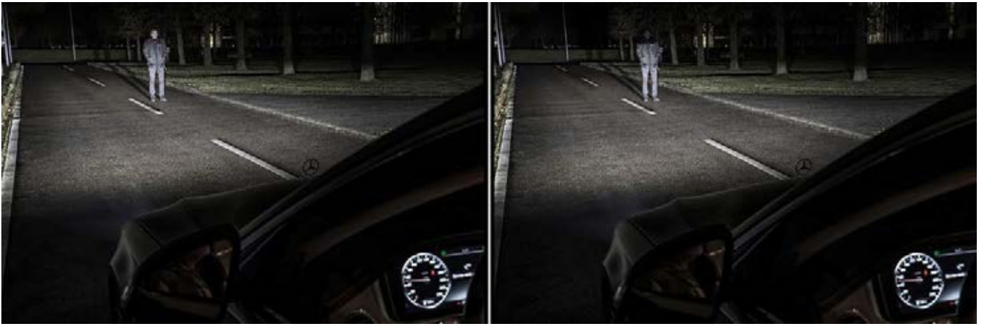
Einzelne Partien können gezielt ausgeblendet werden: Der Fussgänger im rechten Bild wird nicht geblendet.
