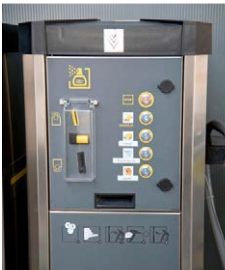
Mit einer Mischung aus ätherischen Ölen desinfiziert der Spender die Teppiche und Teppichböden der Fahrzeuge und verbreitet einen angenehmen Duft.
