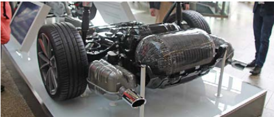
Das Chassis eines A4 g-tron mit seinen beiden Gastanks im Heck.
