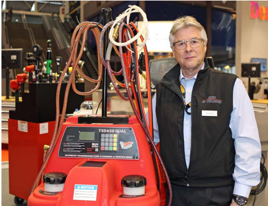
Automatisch Getriebeöl wechseln: KSU/A-Technik-Geschäftsführer Heinz Borel mit dem Automatik-Getriebeöl-Wechslergerät TSD650EU.
