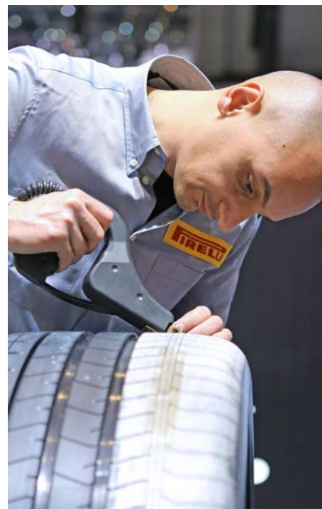
Ein Reifendesigner schnitzte live und von Hand das Profil in den Gummi, so wie Pirelli seine Prototypen herstellt.
